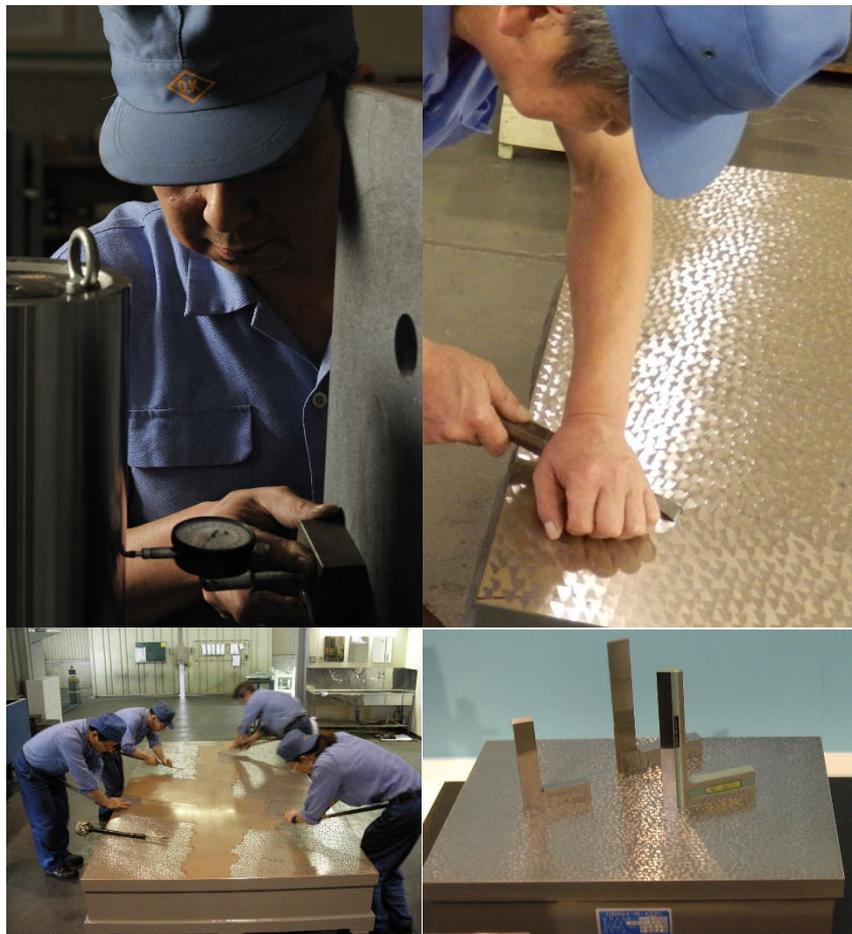
強みの代表のひとつであるウルトラハンドテクノロジーの「キサゲ」と「ラップ」は機械加工では決して生み出せない「平面」を人の手で実現する。これらの匠の技に加え、電気制御およびデータ処理を融合した自動計測装置や専用測定器を、設計から据え付け、立ち上げ一気通貫で顧客ニーズに対応し最適なソリューションを提供している。
