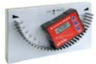
クリノプラスを角度設定装置 (精密角度割り出し装置、サイン台) に設置して、角度を 50 ° に設定します。向かって、右側にあるコネクタ側を下側に傾斜さ
